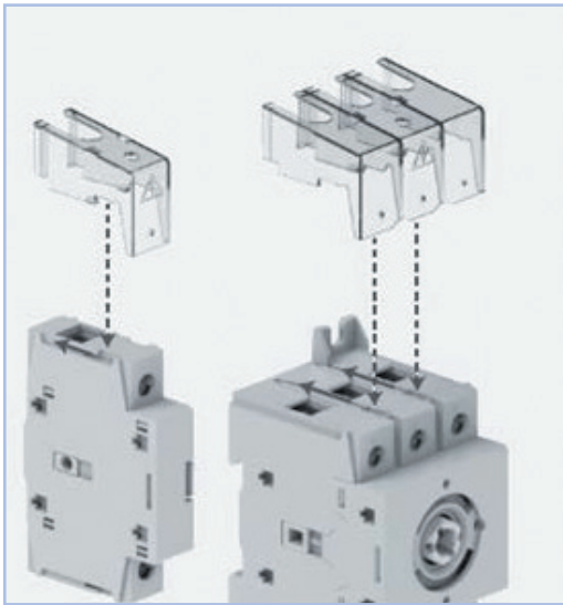
Установка защитных крышек
